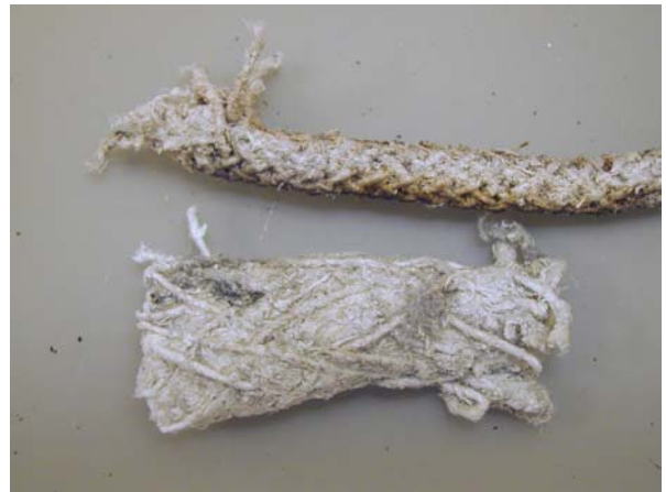
Cordon d'amiante tissé utilisé comme joint de protection de feu, photo: JMF, IST
