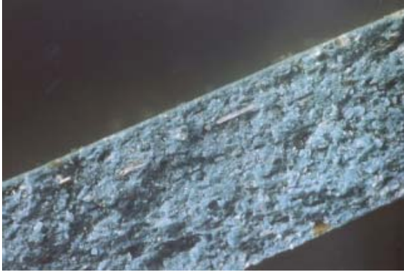
Tranche d'une dalle de revêtement de sol unicouche contenant de rares faisceaux de fibres d'amiante blancs, photo: SA
